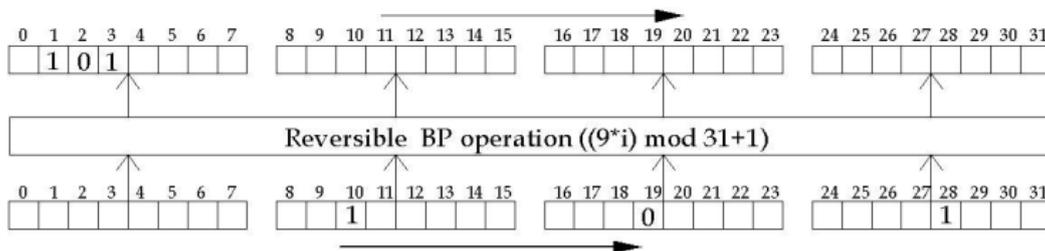
**Fig11. 32bit REVERSE BIT PERMUTATION**
