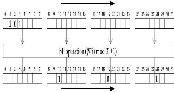
Fig5. 32bit BIT PERMUTATION
